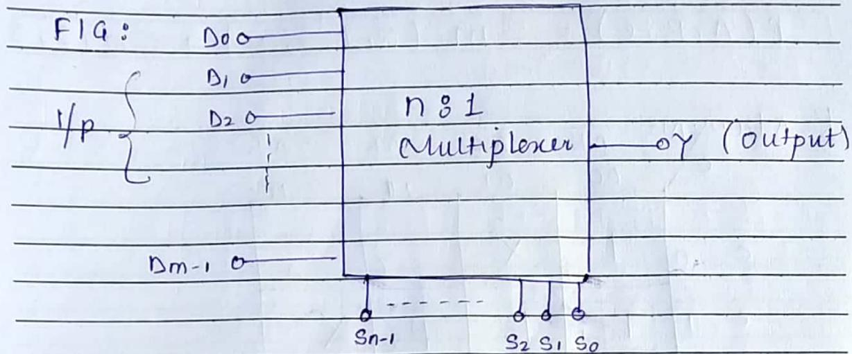
fig: Block dig of multiplexer
